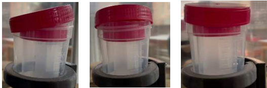
Fig. 4. SC isolator cap anomalies
