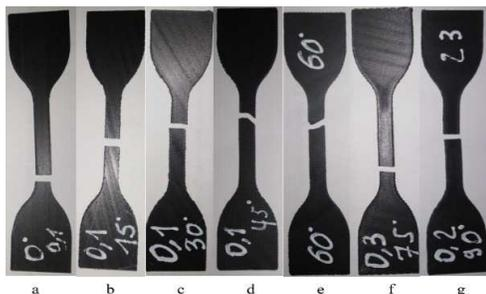
Fig. 4. Photos of the specimens after testing: a) 0°, b) 15°, c) 30°, d) 45°, e) 60°, f) 75°, g) 90°
