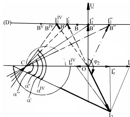
Fig. 5. Phase diagram for  $P_2=\text{const.}$ ,  $\cos\varphi_2=\text{const.}$ ,  $\alpha \neq \text{var}$
